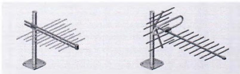
Оба типа принимают дециметровые волны – 21-60 телевизионные каналы (ТВК). Логопериодическая антенна выручает, если мультиплексы передаются на сильно удаленных друг от друга частотах. Например, если первый мультиплекс транслируется на 24 ТВК, а второй – на 58 ТВК. В случае, если разница между ТВК не более чем на 10-15 единиц, оптимальный выбор – антенна «волновой канал». Узнать ТВК мультиплексов в Воронежской области можно на сайте [карта.ртрс.рф](http://карта.ртрс.рф).
